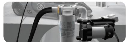
Grupo certificado UL/CSA para transferencia de líquidos inflamables: gasolina, queroseno y diésel. Bomba con porta pistola, fácil de instalar sobre un barril por medio de la conexión principal de 2". La unidad equipada con tubo telescopico de aspiración para la conexión directa al tanque permite el uso limpido y sencillo del dispensador.
